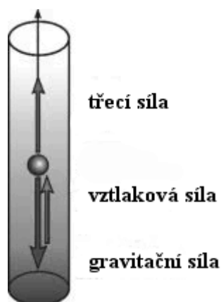
Obr. 6 Rozložení sil při sedimentaci částice v gravitačním poli. Upraveno podle Bartovská a Šišková, 2005a.
