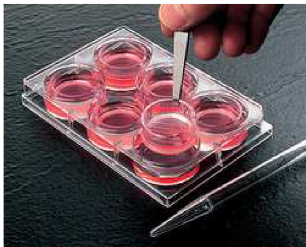
Obrázek 4 Inset s membránou k vložení do 6-jamkové desky
