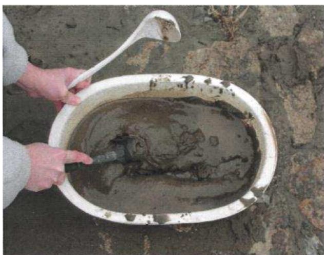
Obr. 8 a Obr. 9 - Odběr vzorku sedimentu běžnou naběračkou (Obr. 8) penetrační tyčí (Obr. 9) (ČHMÚ, 2006)
