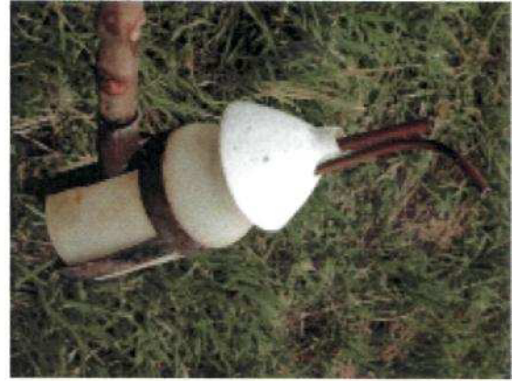
Obr. 4 - Vzorkovací nádoba obsahu 1 dm 3 pro odběr plaveniny (ČHMÚ, 2006)
