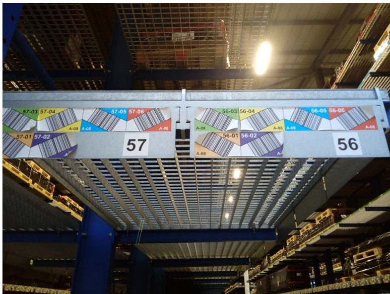
Obrázek 11 - čárové kódy pozic v exportním skladu
