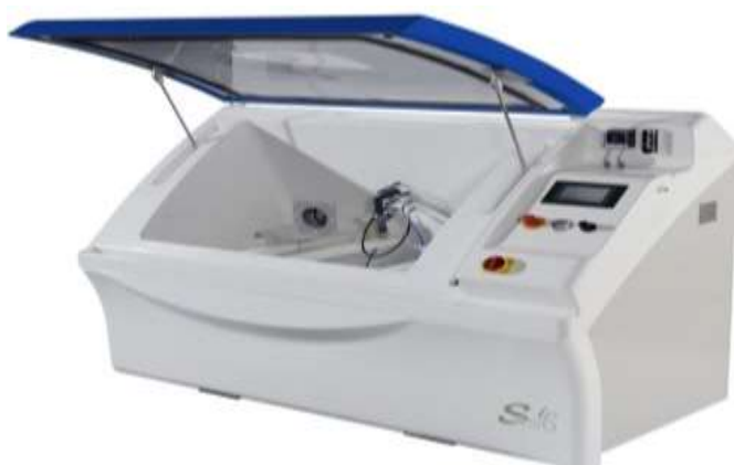
Obrázek č. 16 Solná komora
