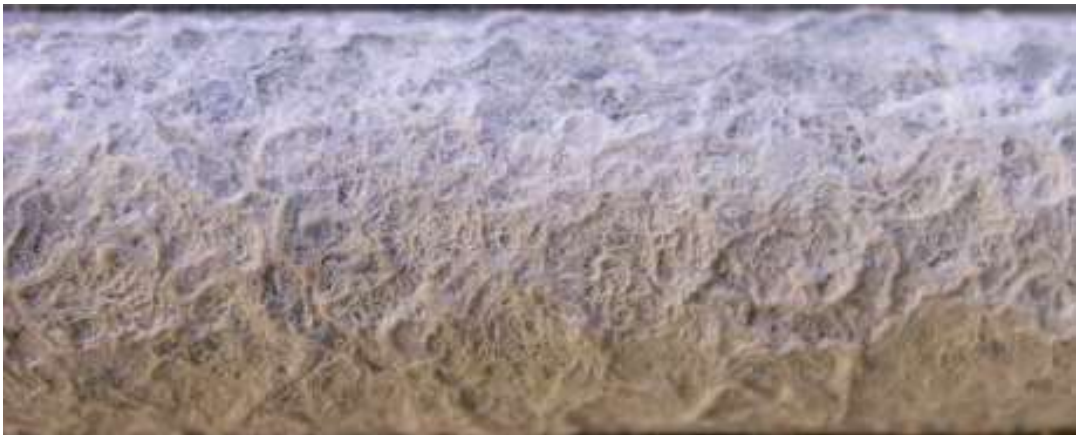
Obrázek č. 20 Zkušební vzorek po mechanickém namáhání po 10 dnech
