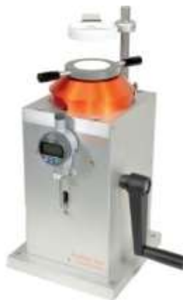
Obrázek č. 13 Zkušební zařízení pro zkoušku hloubením
