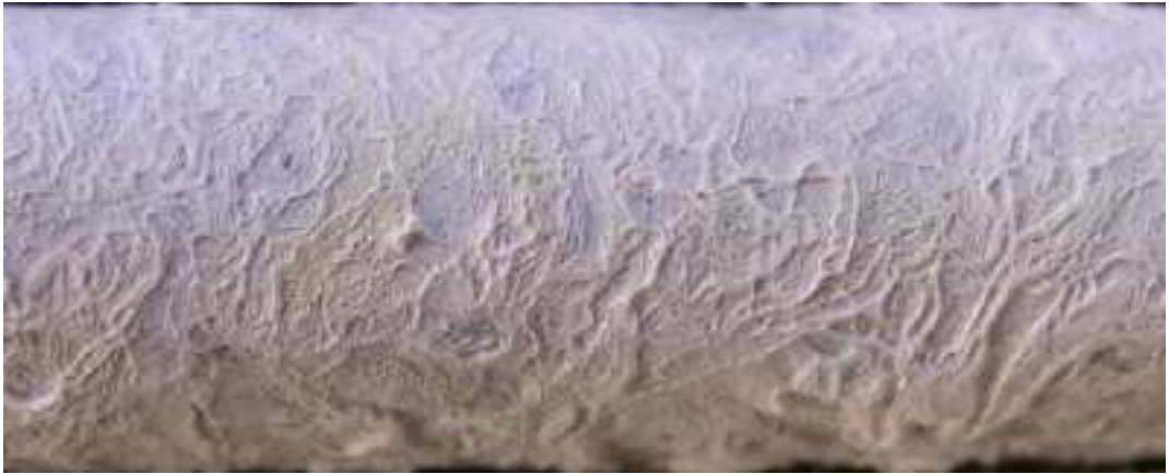
Obrázek č. 19 Zkušební vzorek po mechanickém namáhání po 10 dnech.
