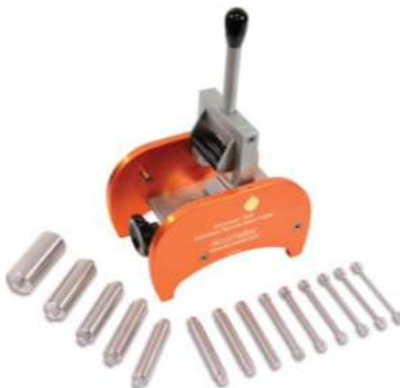
Obrázek č. 15 Zařízení pro zkoušku ohybem přes válcový trn se zkušebními trny
