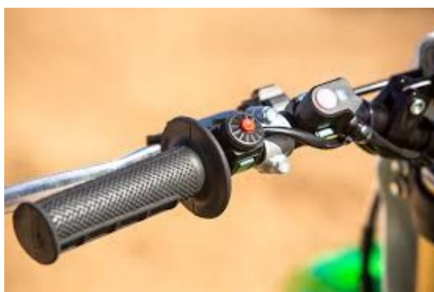
Obrázek 9: Launch Control u Kawasaki KX250F
