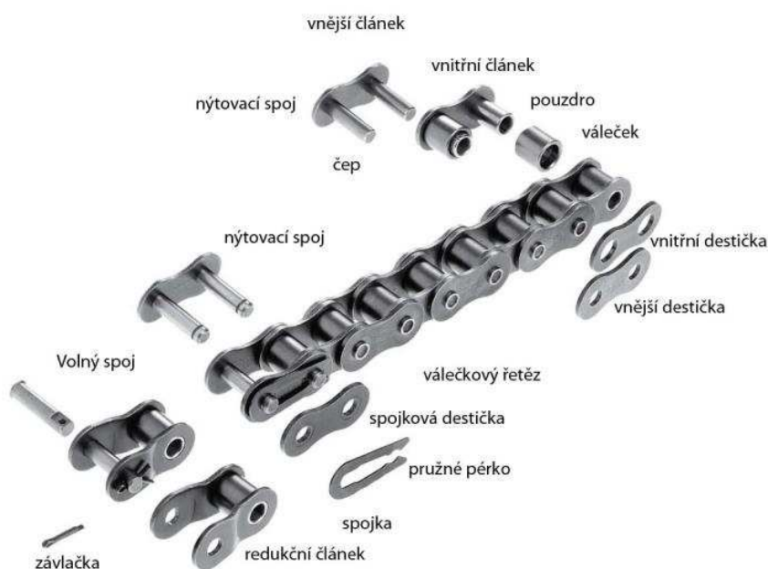
Obrázek 16 Konstrukce válečkového řetězu (zdroj: http://www.contra.cz/cz/retezovy_prevod/konstrukce_valeckoveho_retezu.html )
