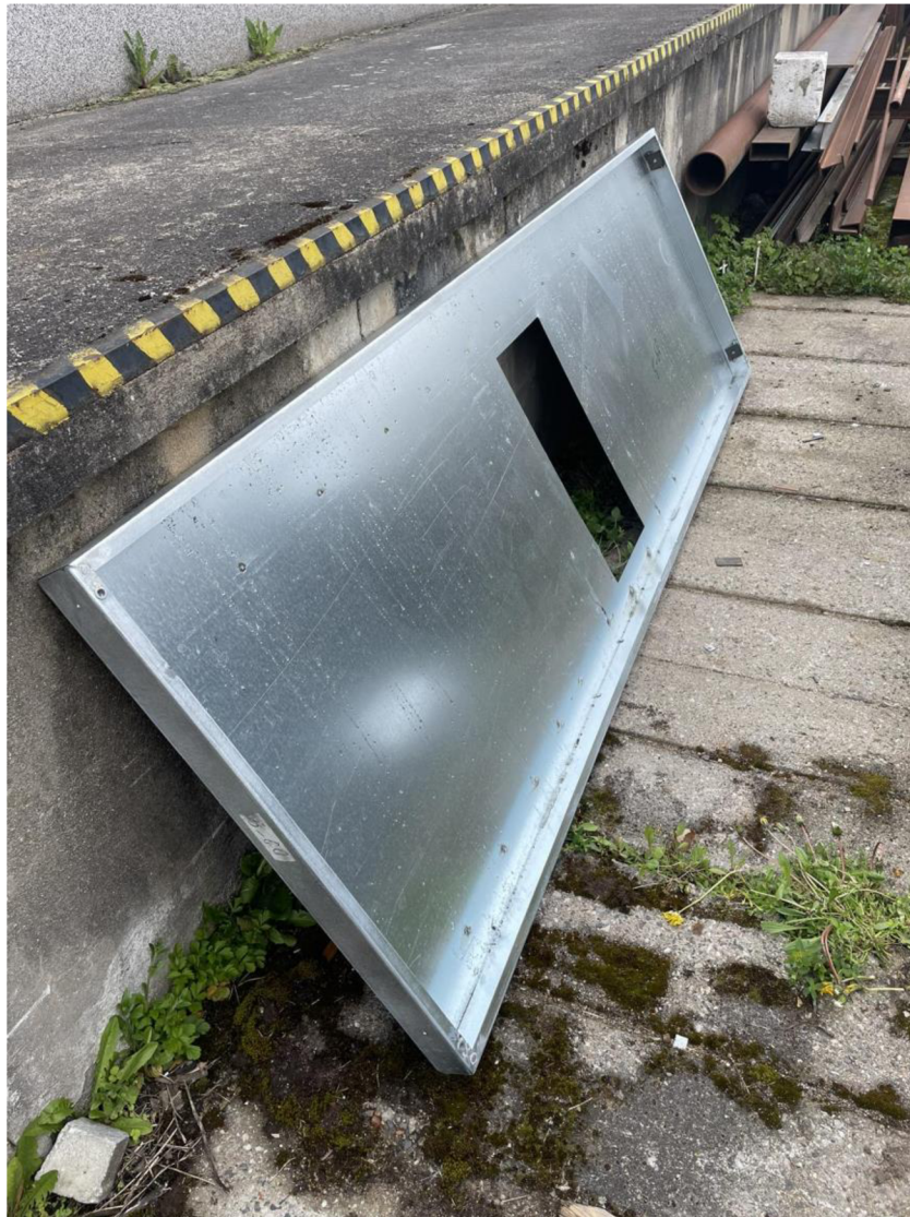
Obrázek 17: Špatně vyrobený panel [Vlastní]
