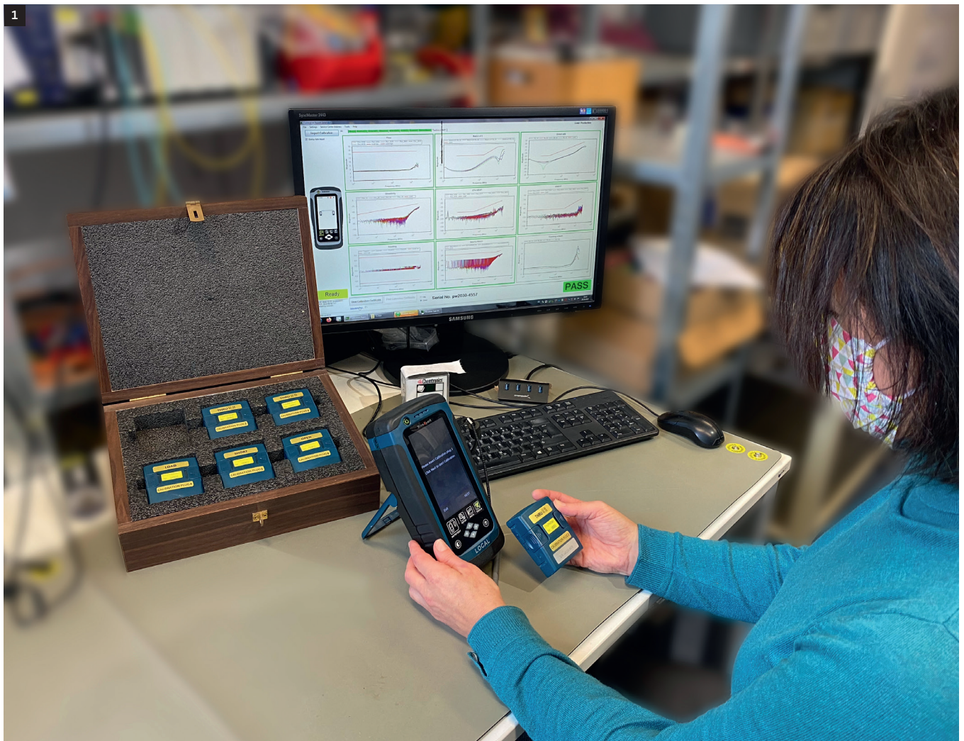
Bild 1: Kalibrierartefakte für die Kalibrierung der Hochfrequenzeigenschaften eines »Wirexpert« in Verbindung mit spezieller Kalibriersoftware
