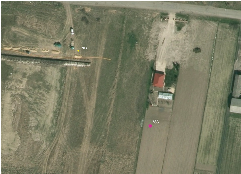
Rys. 4. Zmiany położenia punktów monitoringowych z powodu pojawienia się zabudowy jednorodzinnej i ogrodzenia terenu (powyżej) oraz budowy szlaków komunikacyjnych (u dołu).
