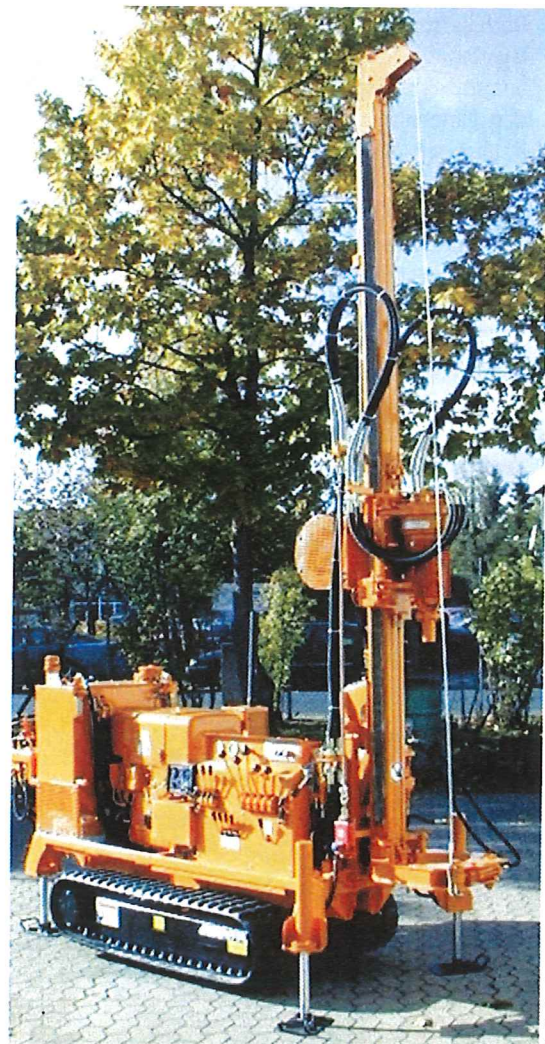
Abb. 4 Mit dem Rammsondiergerät können u. a. Kleinbohrverfahren in Böden gemäß DIN 4021 maschinell ausgeführt werden.
