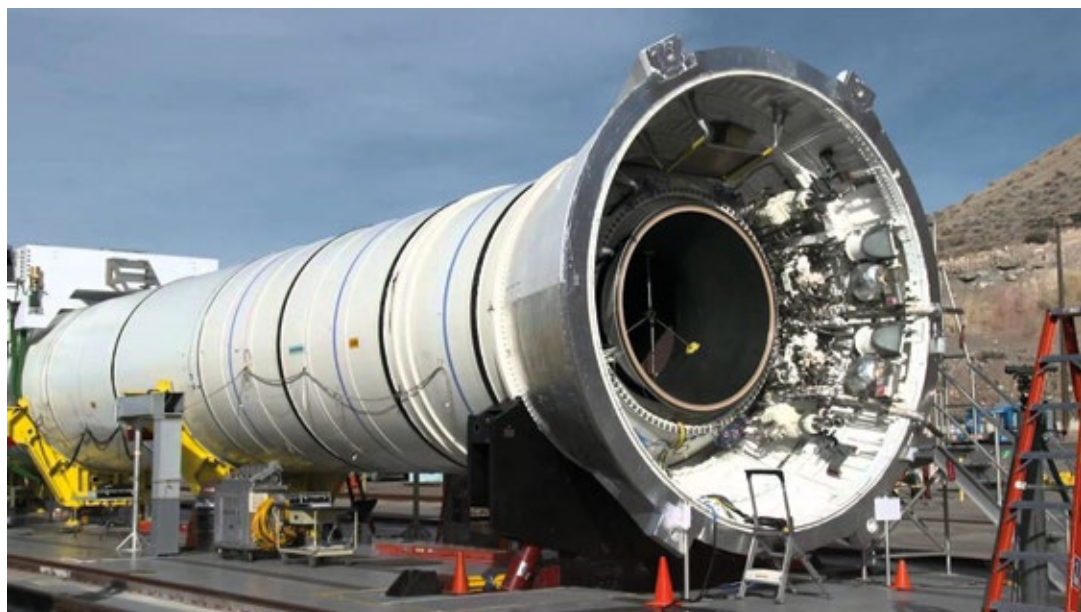
Obr. 8: Demontovaná SRB (zdroj: collectspace.com) |
