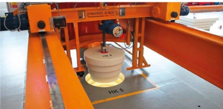
Obr. 2: Zavážecí zařízení otvírá stropní zátku horké komory
