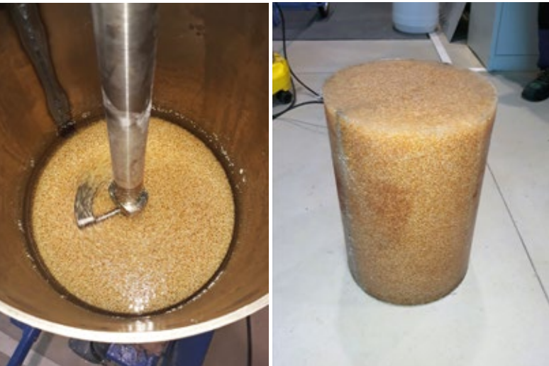
Obr. 2: Příprava polysiloxanové matrice
