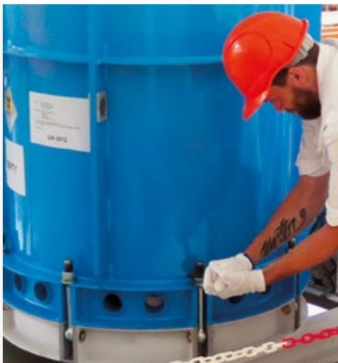
Obr. 10: Obsluha přimontuje k OS zpět protipádovou ochranu a připraví jej k transportu
