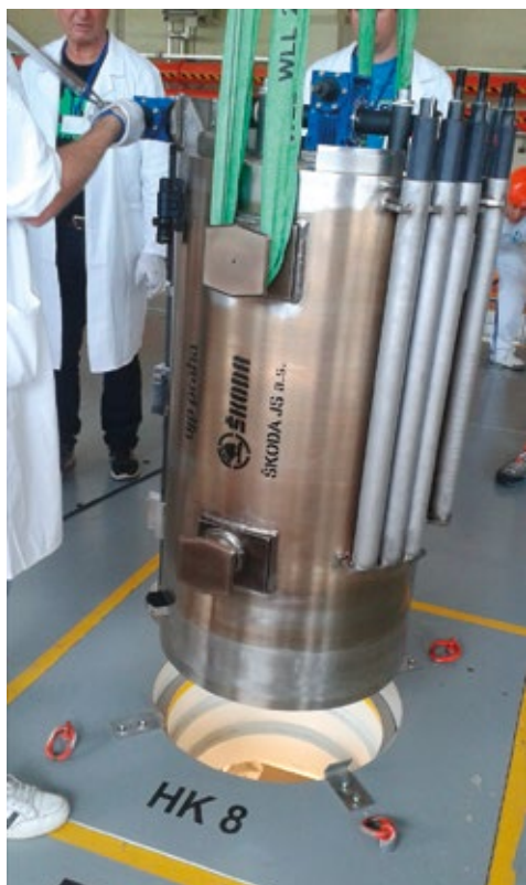
Obr. 6: Ve vertikální pozici se pomocí jeřábu přesune na připravené (odzátkované) sedlo na stropní desce horké komory |
