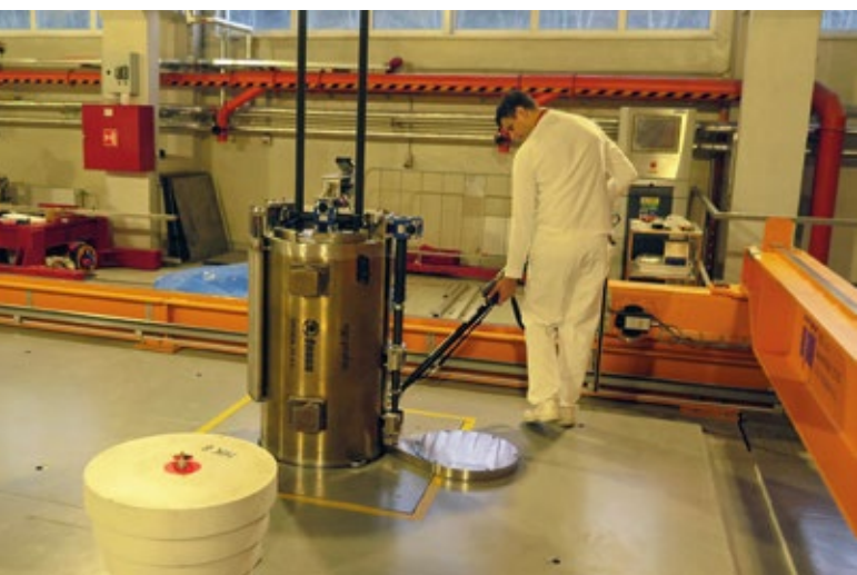
Obr. 7: Po dosednutí obalového souboru na hrdlo komory se provede dozimetrická kontrola radiální těsnosti spojení
