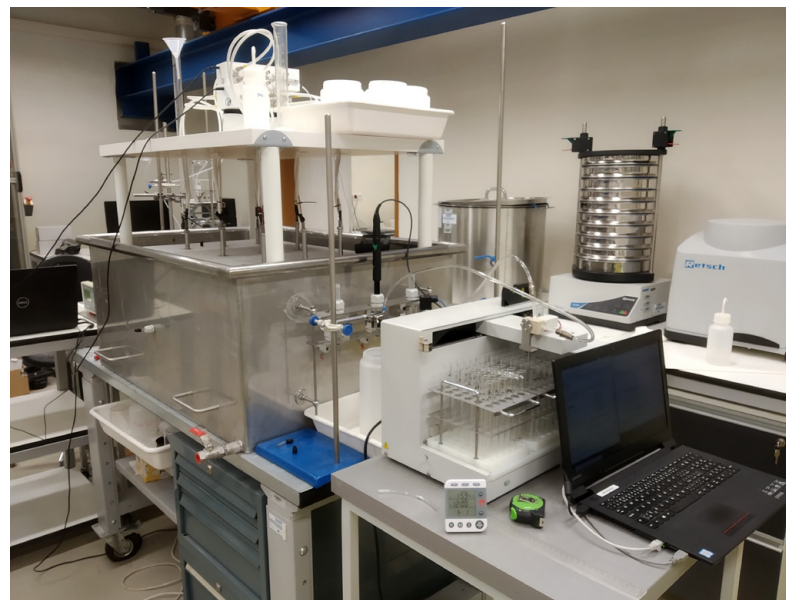
Obr. 2 Experimentální sestava při stopovacích experimentech (blok MS2 v nerezové vaně)
