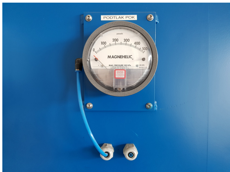
Obr. 4: Diferenční manometr Magnehelic |
