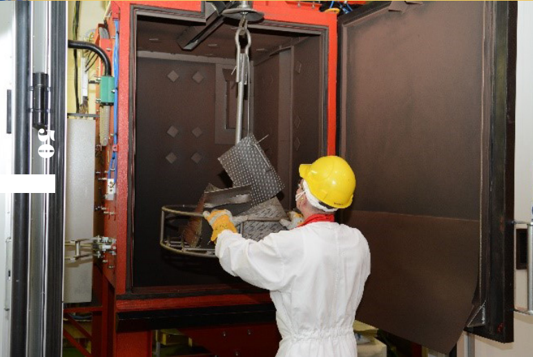
Obr. 1: Spracovanie RKM na Dekontaminačnej a fragmentačnej linke inštalovanej v HVB[9]JE V1 a v strojovni JE A1
