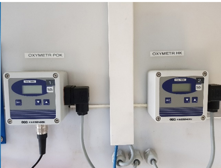
Obr. 5: Vnitřní a vnější zobrazovací jednotky oxymetrů OXY 3690 MP pro stanovení hladiny kyslíku uvnitř POK a HK
