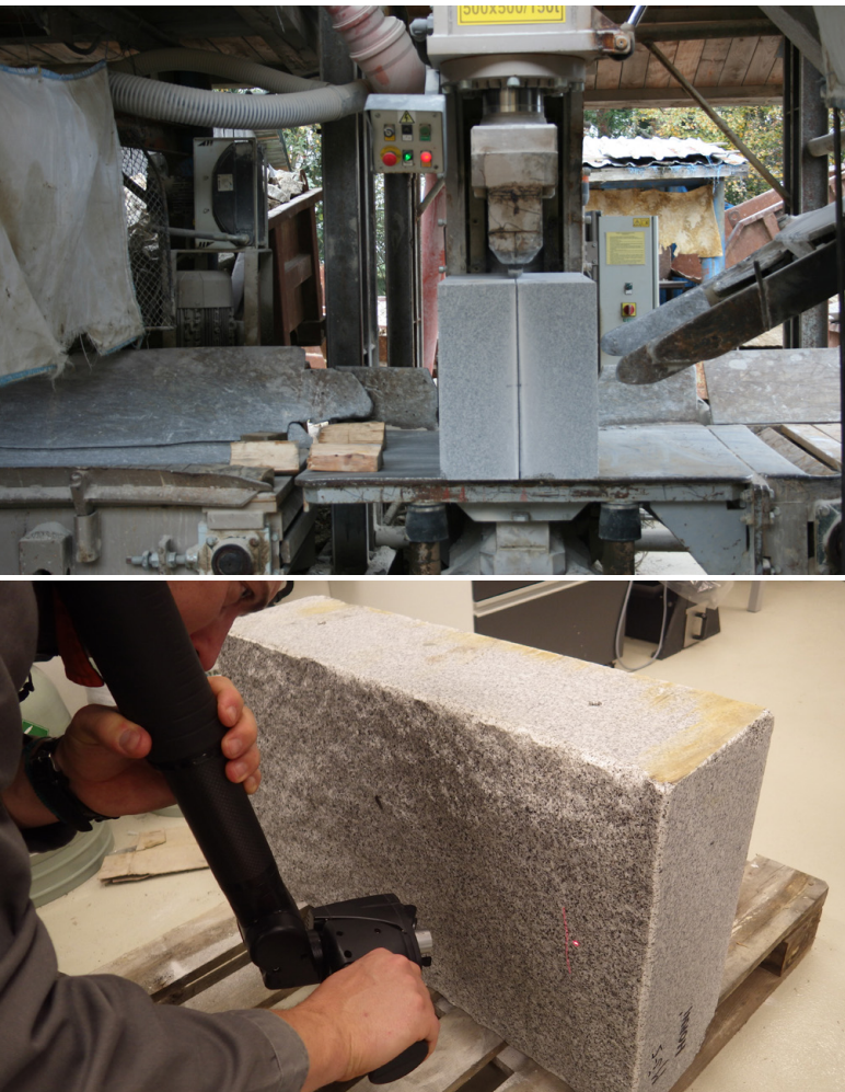
Obr. 1a, b Proces štípání bloku pro vytvoření fyzikálního modelu (a, nahoře); detailní 3D skenování pukliny před sesazením bloku (b, dole)
