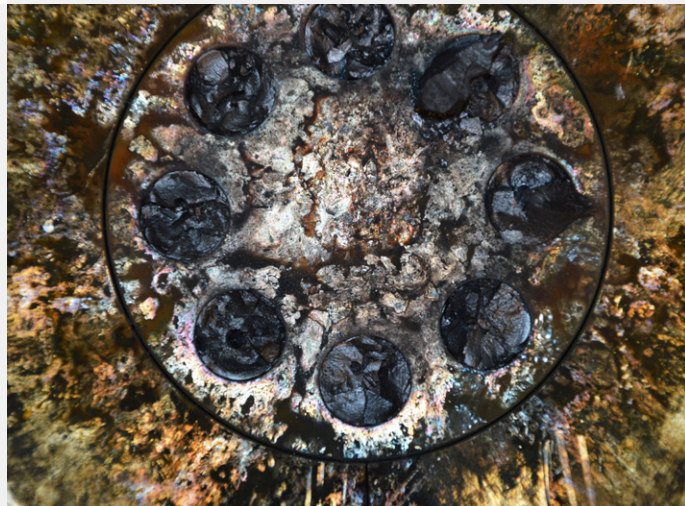
Obr. 5: Vzorek eliptického perforovaného dna nosného válce (a), vzorek po experimentu (b) |
