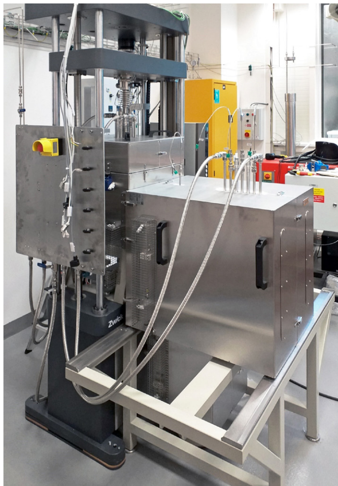
Obr. 7: Autokláv pro mechanické zkoušky v eutektiku Pb-Li |
