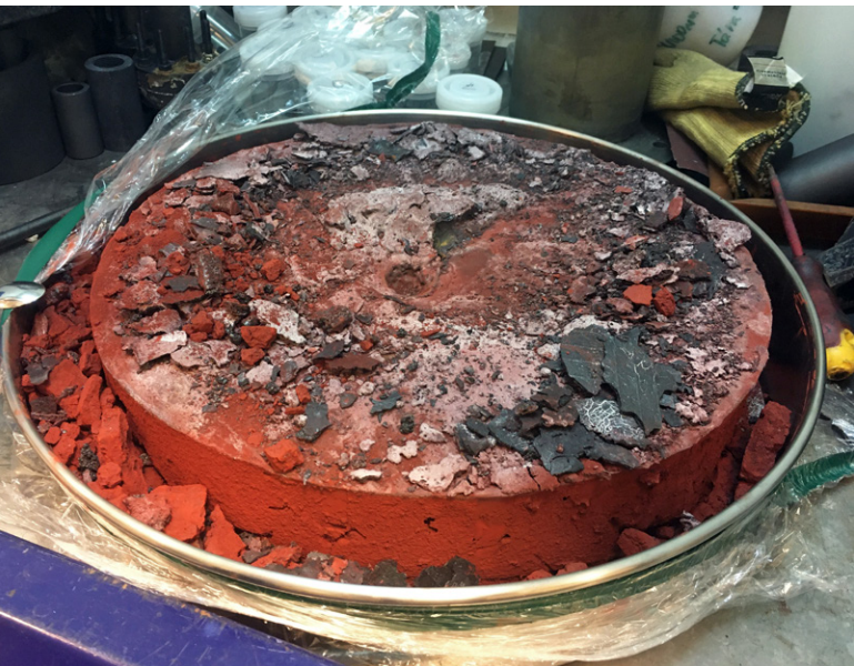
Experiment výlevu roztaveného koria na core catcher v rámci spolupráce s Mitsubishi Heavy Industries
