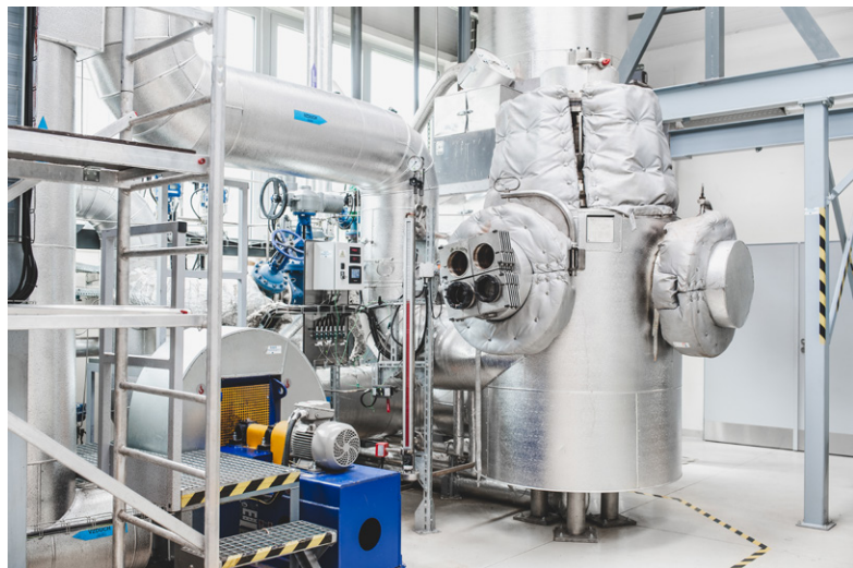
Obr. 3: Zařízení LOCA určené ke kvalifikaci komponent v podmínkách těžkých havárií
