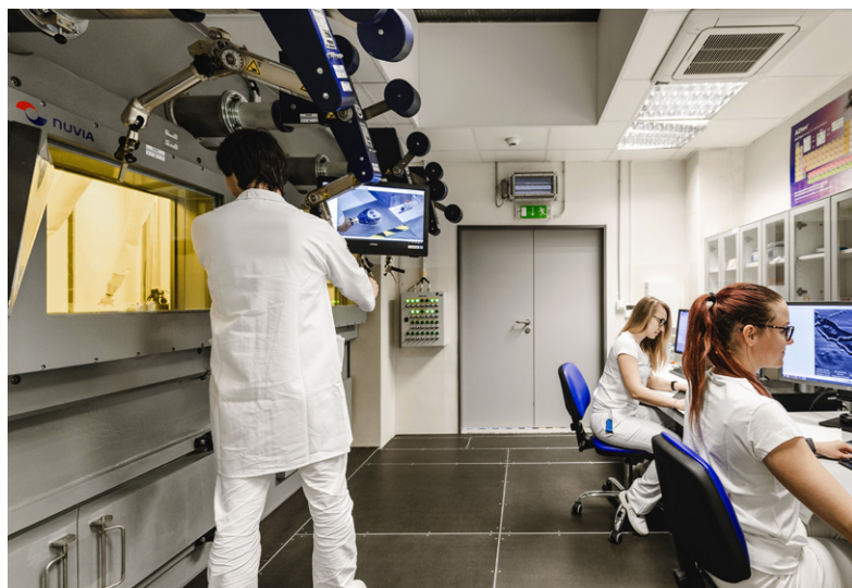
Obr. 1: Operátorovna polohorké komory se světelným mikroskopem, skenovacím elektronovým mikroskopem a nanoindentorem
