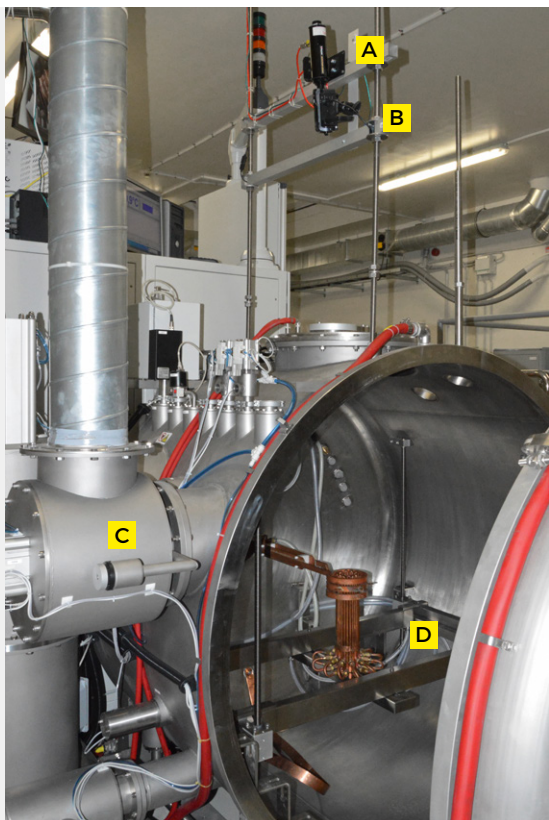
Obr. 1: Vysokofrekvenční indukční pec s příslušenstvím (a), schematické znázornění indukční pece se studeným kelímkem, 1 – induktor, 2 – tavenina, 3 – stěna studeného kelímku, 4 – dno studeného kelímku (b)
