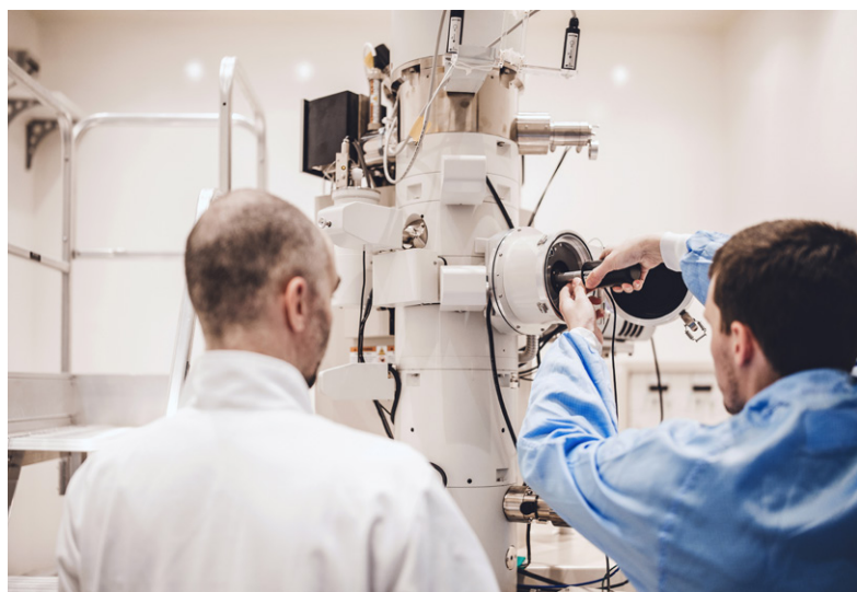
Obr. 2: Transmisní elektronový mikroskop pro charakterizaci radiačně-indukovaných defektů
