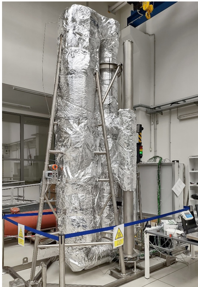
Obr.1: Stend pro testování akumulačního materiálu ve formě kameniva v experimentální hale CVŘ
