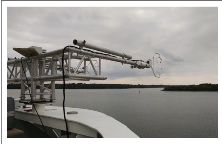
Abb. 1: Mast mit Anemometern und Lufteinlässen am Bug der Sonne.
