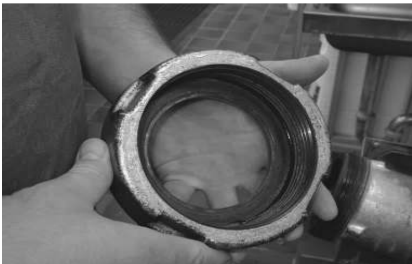
Εικόνα 8: Σκουριά πάνω στις επιφάνειες επειδή δεν αποσυναρμολογήθηκε, δεν καθαρίστηκε και δεν στέγνωσε όπως έπρεπε
