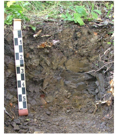
Půdní profil tvoří jen slabě vyvinutý Ai horizont. Půdotvorným substrátem je vytěžený terciární jíl. Stráží profilu cca 30-40 let.
