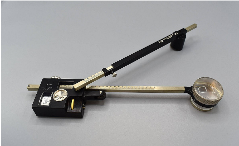
Obrázek 6.7: Polární planimetr. Opisování uzavřené křivky c probíhá pomocí čočky se zaměřovačem umístěné na rameni planimetru. Compensating polar planimeter. National Wildlife Research Center (2021) . Obrázek je volně dostupný z https://commons.wikimedia.org .
