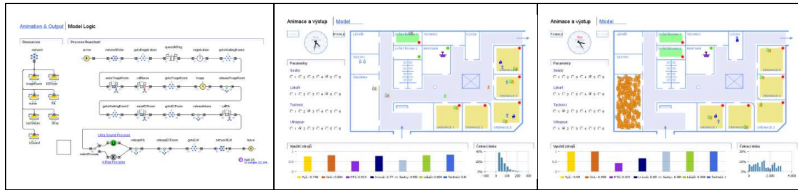
Obrázek 8 - Diskrétně modelované zdravotnické procesy: vlevo model střediska, sestavený z knihovních prvků, uprostřed a vpravo ukázky uživatelského rozhraní pro normální a zdrojově poddimenzovaný případ. Vytvořeno s využitím veřejných modelů firmy XJ Technologies.
