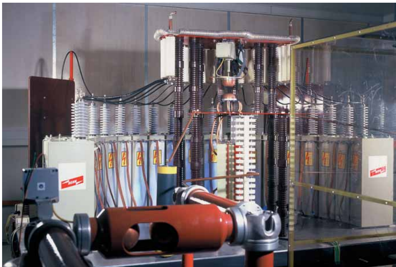
JOONIS 1. IMPULSSVOOLU LABOR DEHN + SÖHNE. MAKSIMAALNE VÄLGU IMPULSSVOOL 200 kA, LAINEKUJU 10/350 \mu s
