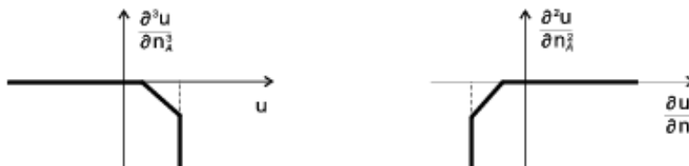
Obr. 12: Znázornění podmínek pro jednostrannou pružnou podporu s omezením
