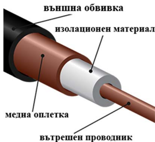
фигура 7 Структура на коаксиален кабел
