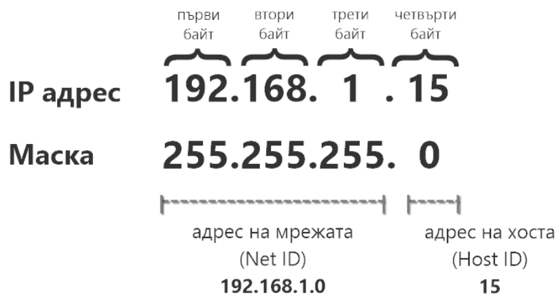
фигура 2 Структура и деление на IP адрес
