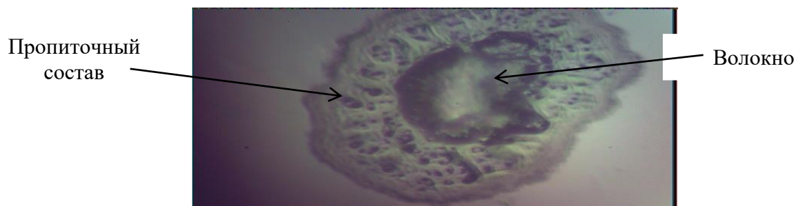
Рис. 1. Поперечный срез обработанного полиэфирного волокна, х400
