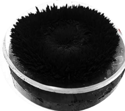
Рис. 1. Магнитные свойства сорбента на основе гуминовой кислоты
