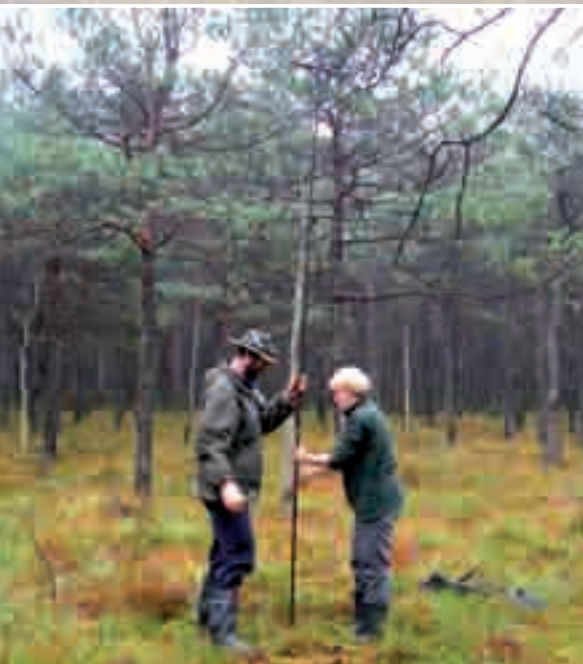
Fot. 2. Właściwe rozpoznanie torfowisk jest niezbędne dla ich ochrony. Wiercenie rozpoznające stratygrafię torfowiska. Fot P. Pawlaczyk
