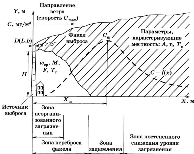
Рисунок 3 Распределение приземной концентрации загрязняющего вещества в атмосферном воздухе на оси факела выброса из точечного источника
