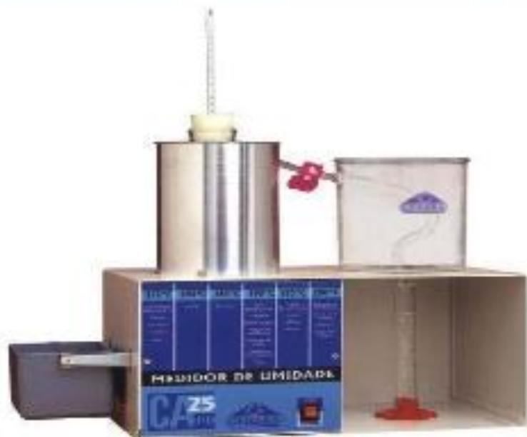
Medidor de umidade pelo método da destilação.
