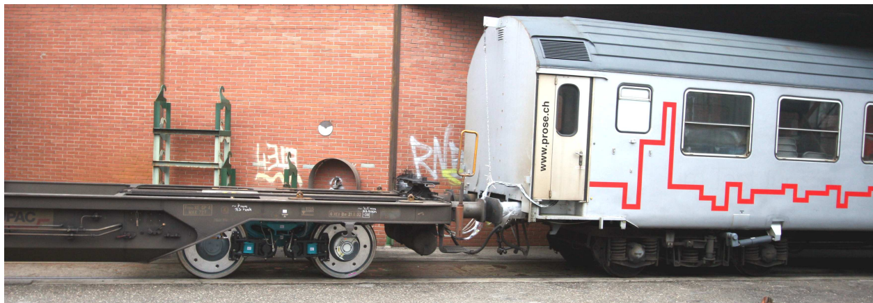
Abbildung 3.1: Messdrehgestell des Taschenwagens, der mit dem Messwagen gekuppelt ist
