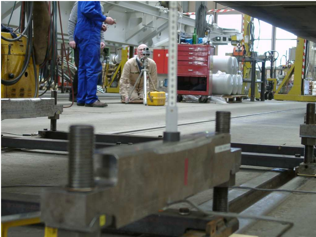
Abbildung 2.2: Wiegeeinrichtung: Nivellieren der Balkenhöhen
