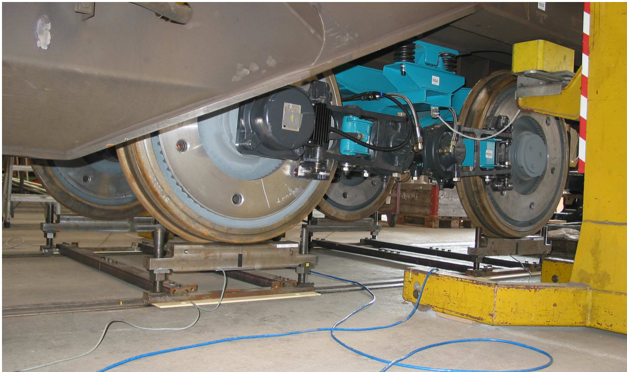
Abbildung 2.1: Wiegeeinrichtung: Messbalken je Radaufstand
