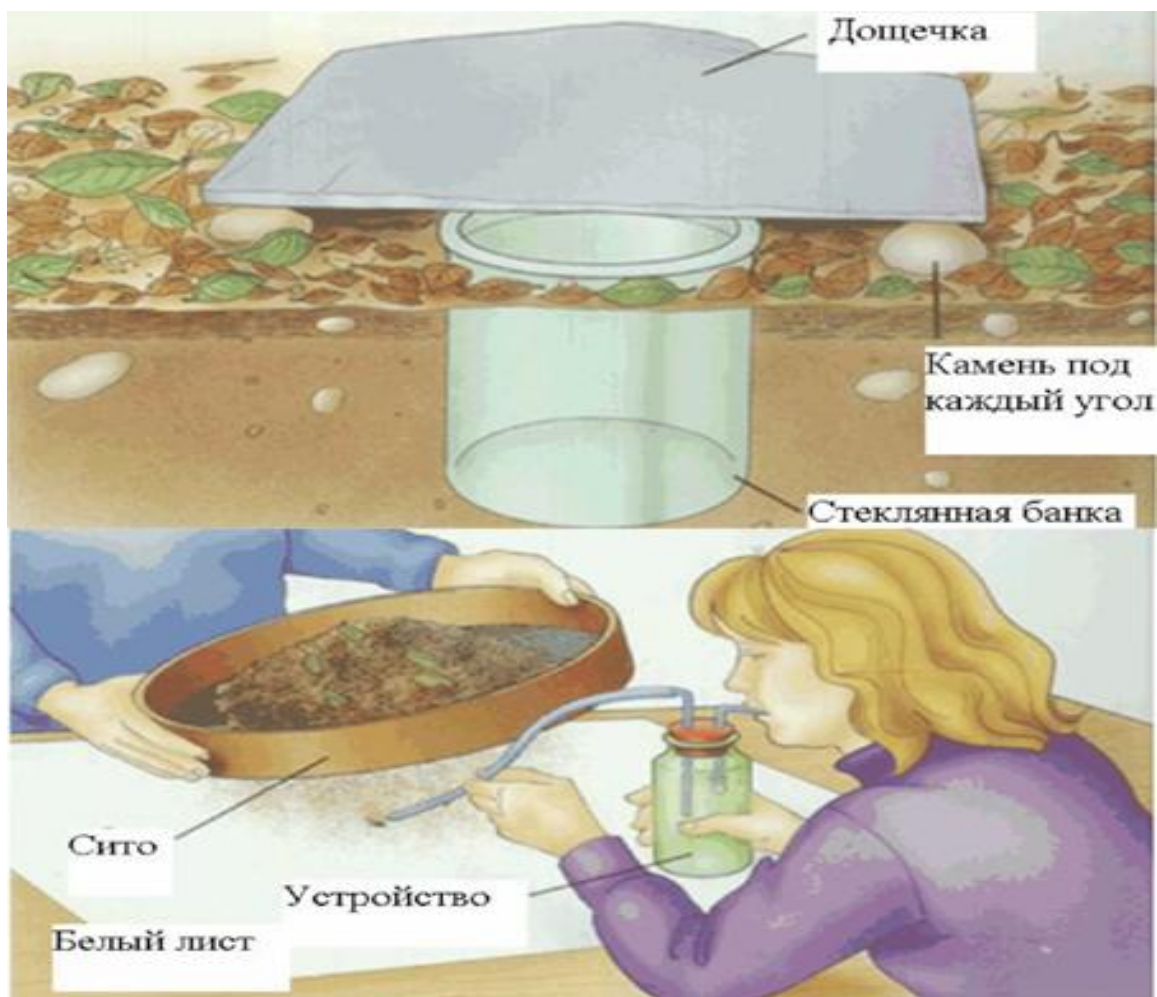
Рисунок 4.2 - Устройство ловушки для знакомства с обитателями подстилки
