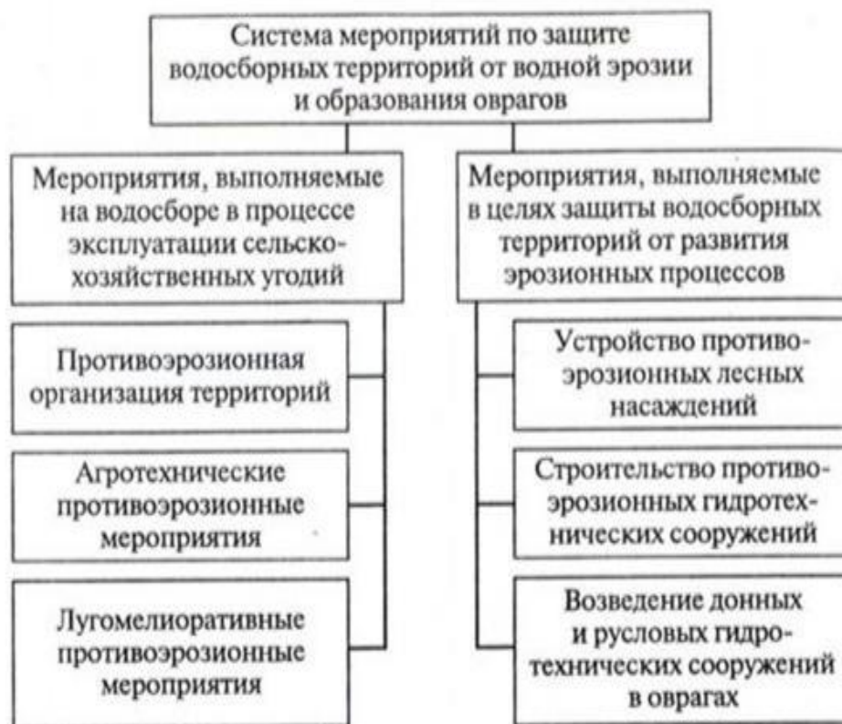
Рисунок 7.2 – Системы мероприятий по защите водосборных территорий от водной эрозии и образования оврагов
