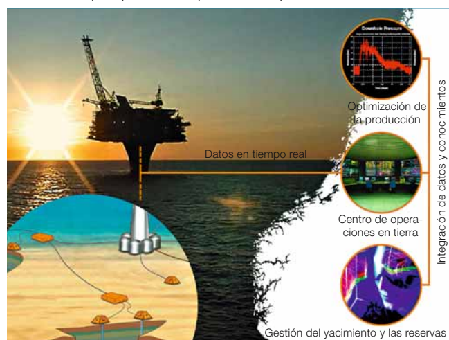
1 Elementos principales de una plataforma de producción en el Mar del Norte
