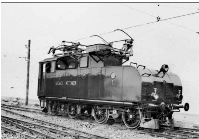
3 Locomotora experimental MFO n.º 1 con convertidor rotativo y motores de tracción de CC
