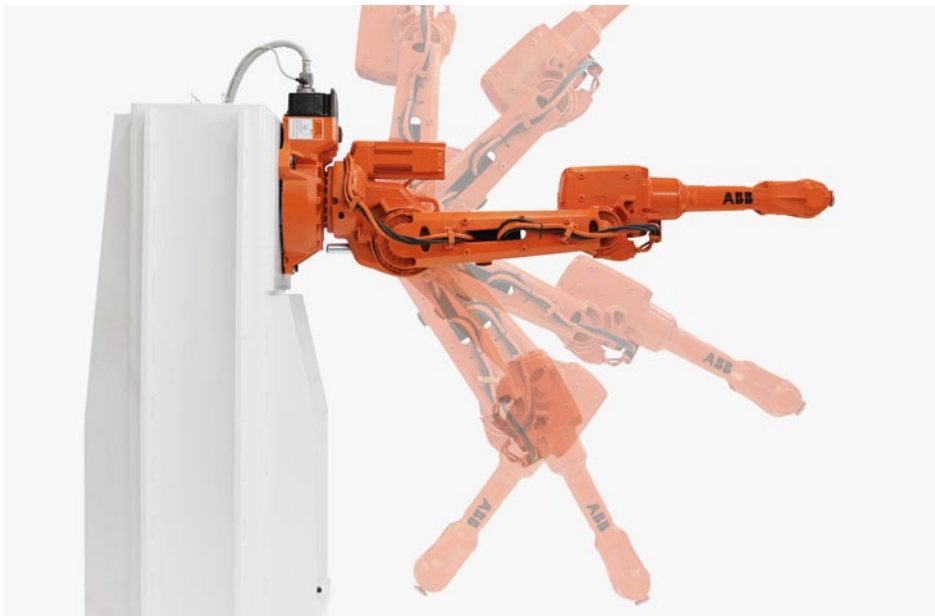
2010 ABB uvedlo na trh robot IRB 2600 nabízející užitečné zatížení 20 kg a obrovský pracovní záběr. Ve své třídě má nejnižší příkon.
