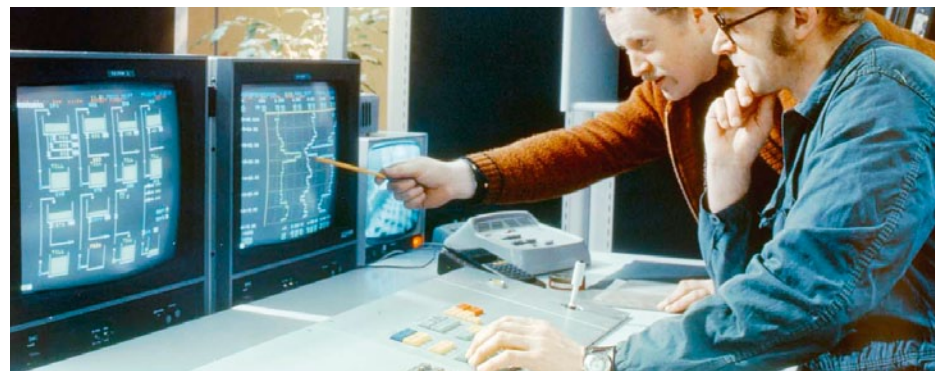
1983 Na trh byl uveden systém barevného zobrazení Tesselator, který podával obsluhujícímu personálu přehledný obraz automatizovaných procesů.
