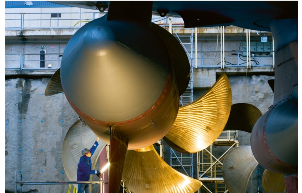
2009 Jednotka Azipod v suchém doku. Jádrem obsahuje vysoce účinný elektrický motor pohánějící vrtuli a přináší nejen úsporu místa na palubě pro další náklad, ale i vyšší přizpůsobivost designu.
