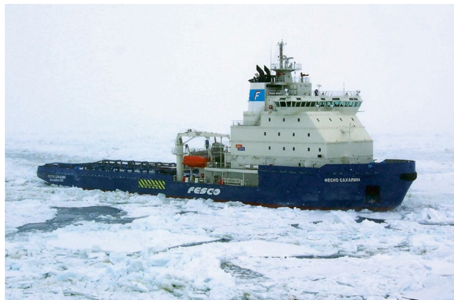
2006 Ledoborec a pomocná loď Fesco Sakhalin začínají využívat dvě jednotky Azipod s výkonem 6,5 MW.
