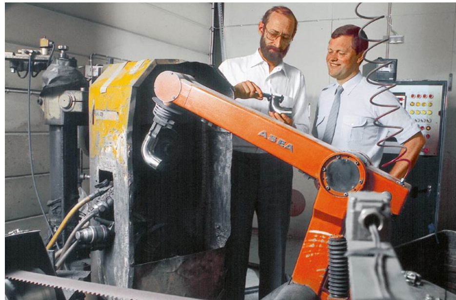
1974 Prvním externím zákazníkem, který si pořídil robota společnosti Asea, byla společnost Magnusson AB, která jej využívala k leštění nerezových ocelových trubek určených pro potravinářský průmysl.
