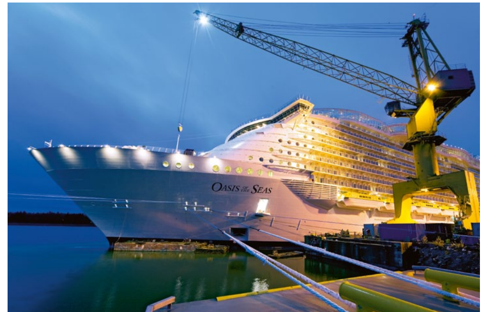
2009 Na vodu byla spuštěna loď Oasis of the Seas. V současnosti je to největší loď, která kdy byla na světě vyrobena, a také první, která bude vybavena třemi plně řízenými jednotkami Azipod. Na takovýchto luxusních výletních lodích jsou výhody nízké hlučnosti systému Azipod zvláště důležité.
