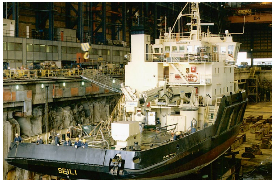
1990 Dopravní obslužná loď Seili byla vybavena prvním prototypem systému Azipod. Pohon Azipod byl již instalován do 81 plavidel a má za sebou více než 5 milionů hodin provozu.
