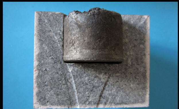
Bild 10: Tiegeltest mit 99% nitridhaltigem Tonerdematerial. Versuchsbedingungen wie oben. Es resultiert eine absolute Nichtbenetzung. Zu beachten ist dass die graue Farbe die Originalfarbe des Feuerfestmaterials ist und nicht aus dem Test stammt; während des Versuchs hat im Gegenteil eine Entfärbung der Außenseite stattgefunden.
