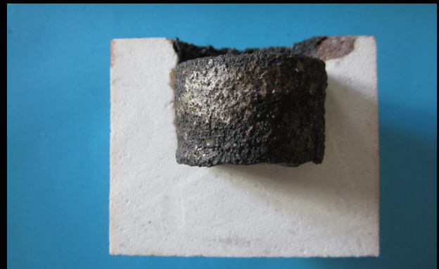
Bild 8 a (links) und b (rechts): Tiegeltest mit 99% Tonerde-Keramikmaterial mit Stahl 1.3816, 2 h bei 1530° C
