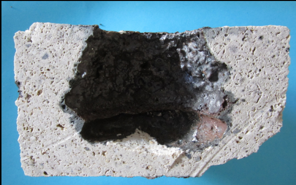
Bild 3 a (links) und b (rechts): Tiegeltest mit Schamottematerial mit Stahl 1.3816, 2 h bei 1530° C, ohne (a) und mit (b) verbleibendem Stahlrest nach Durchbruch
