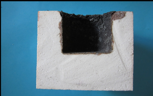
Bild 8 a (links) und b (rechts): Tiegeltest mit 99% Tonerde-Keramikmaterial mit Stahl 1.3816, 2 h bei 1530° C
