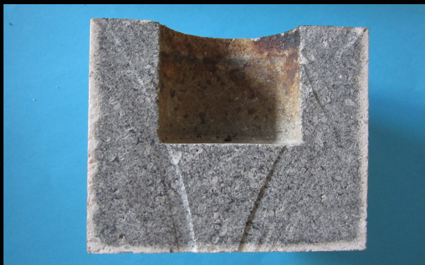
Bild 10: Tiegeltest mit 99% nitridhaltigem Tonerdematerial. Versuchsbedingungen wie oben. Es resultiert eine absolute Nichtbenetzung. Zu beachten ist dass die graue Farbe die Originalfarbe des Feuerfestmaterials ist und nicht aus dem Test stammt; während des Versuchs hat im Gegenteil eine Entfärbung der Außenseite stattgefunden.
