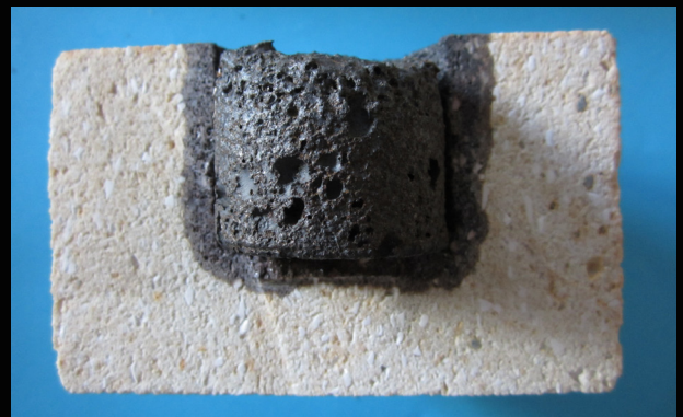
Bild 5 a (links) und b (rechts): Tiegeltest mit verbessertem Feuerfestmaterial der zweiten Generation auf Basis Korund mit vollmullitischer Matrix, Testbedingungen wie oben.
