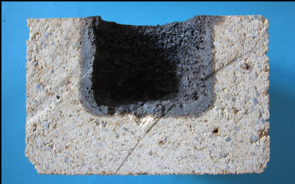
Bild 4 a (links) und b (rechts): Tiegeltest mit verbessertem Feuerfestmaterial der ersten Generation auf Basis Bauxit mit mullitischer Matrix, Testbedingungen wie oben.
