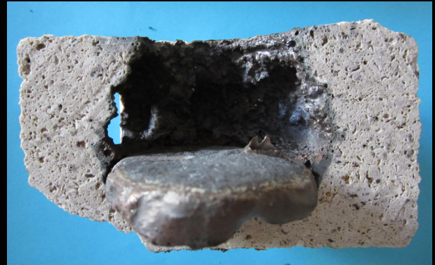
Bild 3 a (links) und b (rechts): Tiegeltest mit Schamottematerial mit Stahl 1.3816, 2 h bei 1530° C, ohne (a) und mit (b) verbleibendem Stahlrest nach Durchbruch
