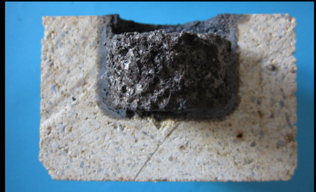
Bild 4 a (links) und b (rechts): Tiegeltest mit verbessertem Feuerfestmaterial der ersten Generation auf Basis Bauxit mit mullitischer Matrix, Testbedingungen wie oben.
