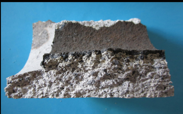
Bild 6 a und 6 b: Bauxitkeramik erste Generation, Kanalsteinstück nach Gebrauch
