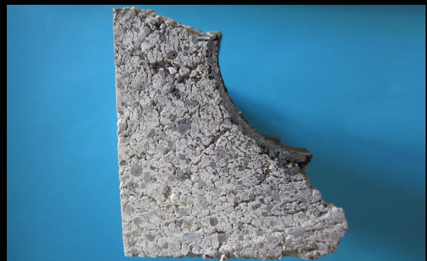
Bild 5 a (links) und b (rechts): Tiegeltest mit verbessertem Feuerfestmaterial der zweiten Generation auf Basis Korund mit vollmullitischer Matrix, Testbedingungen wie oben.
