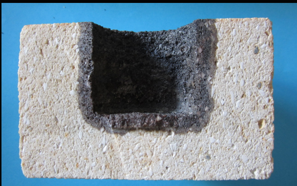
Bild 5 a (links) und b (rechts): Tiegeltest mit verbessertem Feuerfestmaterial der zweiten Generation auf Basis Korund mit vollmullitischer Matrix, Testbedingungen wie oben.
