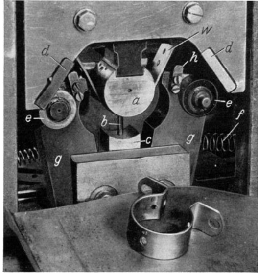
Abb. 243. Schellen-Biegewerkzeug in Arbeitsstellung
