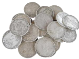
ภาพที่ 3 เงินบริสุทธิและเงินแถบ (เหรียญเงินรูปี) ซึ่งเป็นวัสดุสำคัญของช่างเครื่องเงิน
