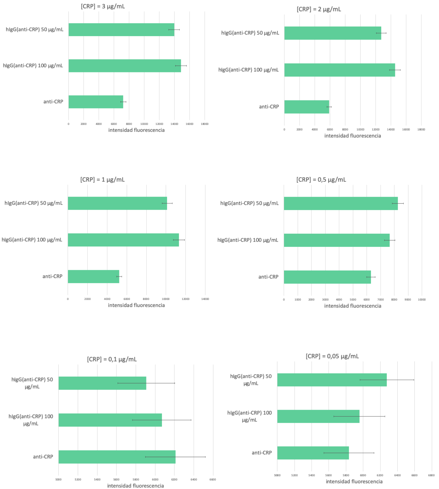
Figura 16: Gráficas en las que se representa la intensidad de fluorescencia registrada en el ensayo con CRP a 3, 2, 1, 0,5, 0,1 y 0,01 µg/mL irradiando 5 minutos a \lambda = 254 nm.
