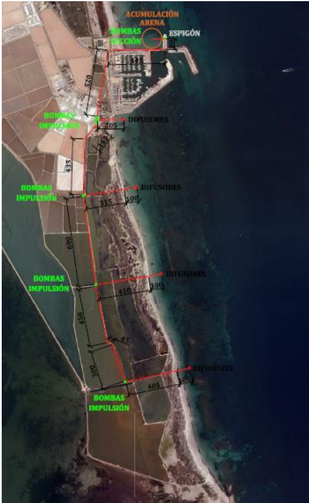
Imagen 105: trazado instalación bypass
