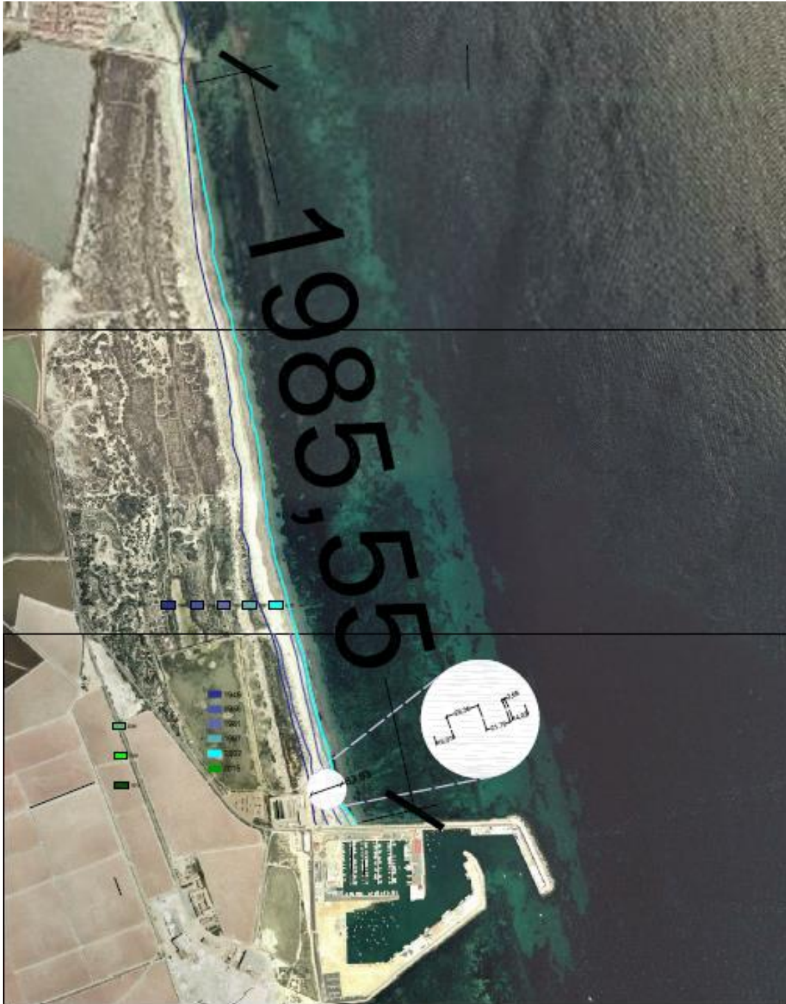
Imagen 54: longitud afectada por la sedimentación al norte del puerto de San Pedro del Pinatar.
