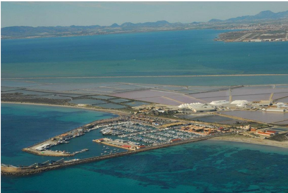
Imagen 88: vista aérea del puerto, observando las diferencias entre las playas situadas al norte y sur del mismo
