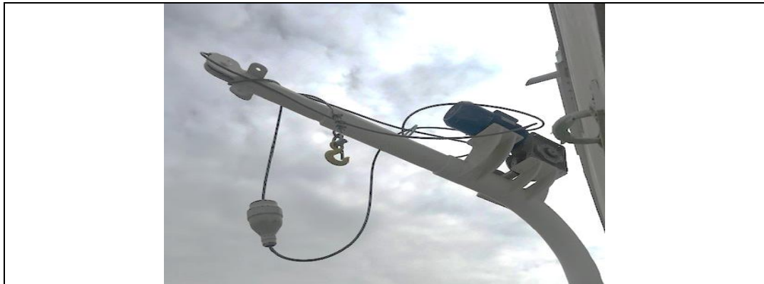
Fotografía 14.- Sistema de izado de pangas (babor y estribor)
