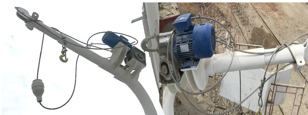
Fotografía 42.- Sistema de izado y arriado de pangas
