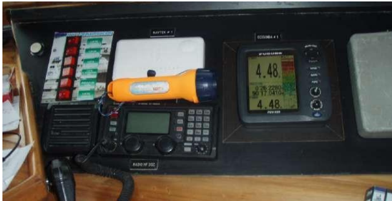
Fotografía 69.- Panel de navegación Navtex, Radio HF, Ecosonda
