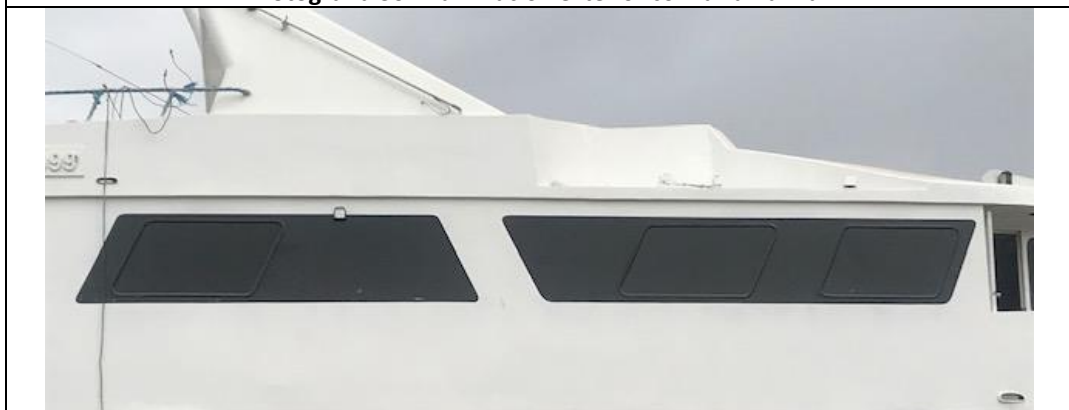
Fotografía 31.- Láminas protectoras colocadas en los vidrios exteriores de la embarcación
