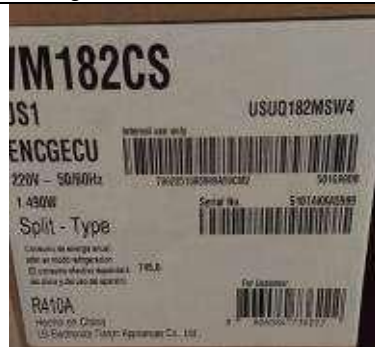
Fotografía 14: Refrigerante Freón R4 10 A del sistema de aire acondicionado.
