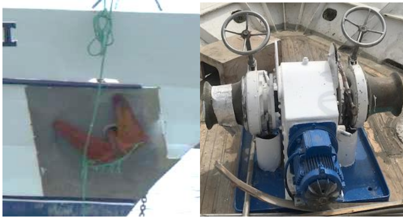
Fotografía 40.- Ancla – Cabrestante eléctrico
