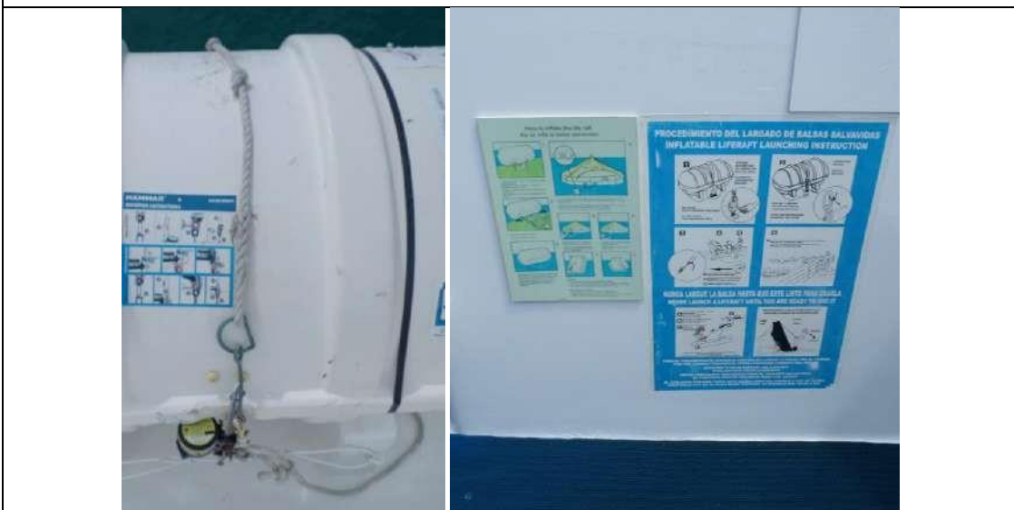
Fotografía 65.- Candado hidrostático –Procedimiento para lanzarlas al mar
