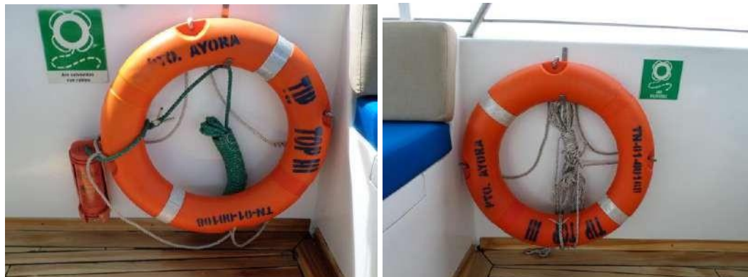
Fotografía 68.- Aros salvavidas con señal luminosa, y con rabiza
