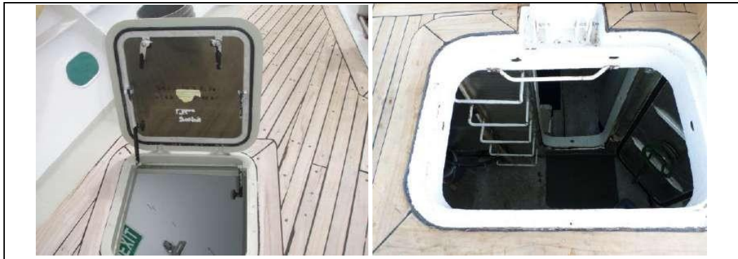
Fotografía 19.- Salidas de emergencia
