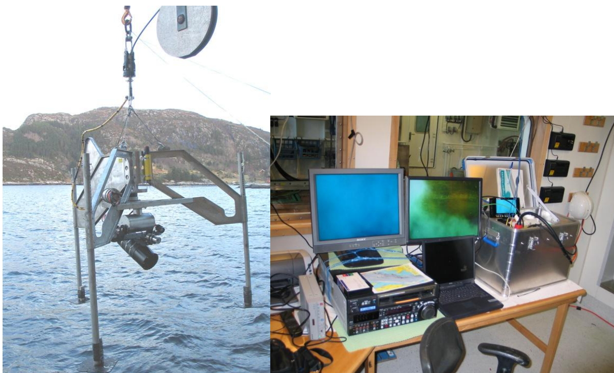
Videoriggen CAMPOD (t.v.) med kontroll- og loggestyr om bord i FF "Håkon Mosby" (t.h.).
