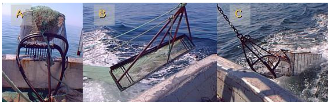
Figura IV-81. A -Ganchorra tradicional; B - Ganchorra do norte; C – Ganchorra de grelha. (Fotografias: Miguel Gaspar).
