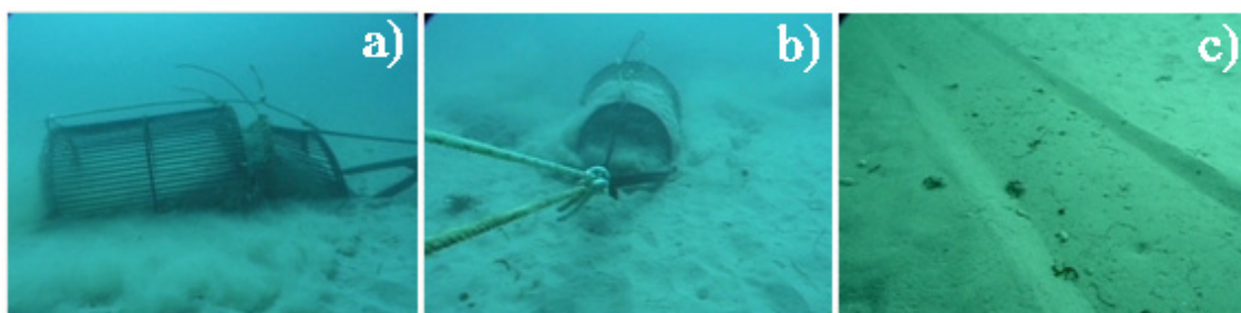
Figura IV-87. a) Aspeto da ganchorra, b) seu modo de funcionamento e c) o respetivo rasto. (Fotografias: Miguel Gaspar).
