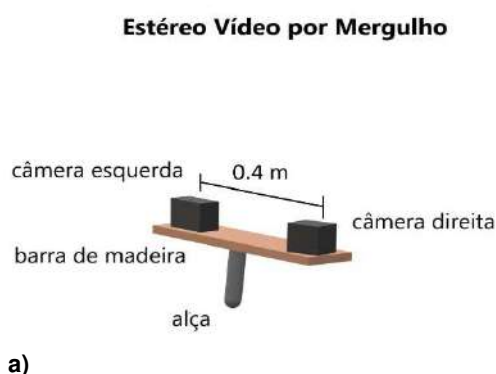
Figura 2.2.2.2.1.1: a) sistema de câmaras de vídeo estéreo operadas por mergulhador (CVEM) utilizado pelo CCMAR (ilustração de Adela Belackova); b) amostragem com CVEM in situ (foto: Thomas Riedinger).
