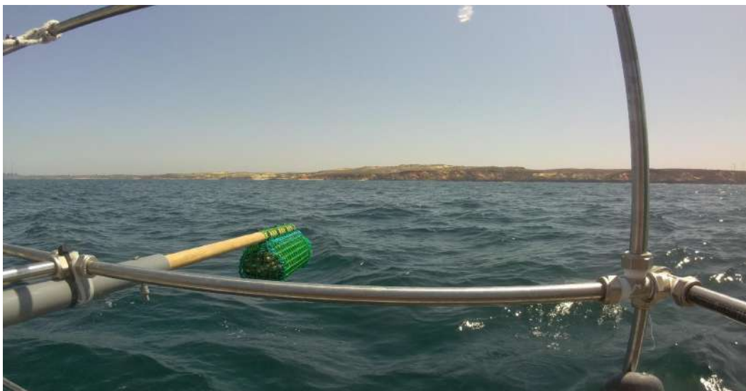
Figura 2.2.3.1.3. Imagem obtida pela câmara direita duma estrutura com câmaras de vídeo estéreo, equipada com caixa de rede com isco e pronta a ser imersa na costa alentejana do PNSACV, a partir de uma embarcação.
