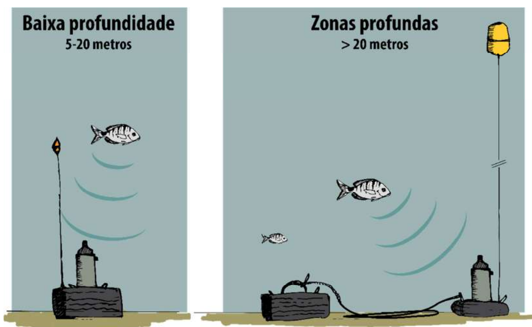
Figura 2.4.2.1.2: Sistemas utilizados para afundamento de poitas onde se colocaram recetores acústicos: poita simples em locais pouco profundos (até 20 m; figura à esquerda) e poitas duplas em locais mais fundos (>20 m; figura à direita) e nos locais da costa oeste (Carrapateira e PPI do Rogil; ilustração de Frederico Oliveira).
