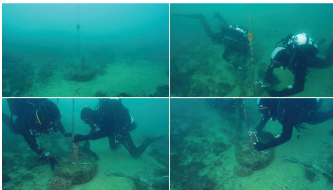
Figura 2.4.2.1.4: Recuperação de recetor acústico (com poita simples) junto a uma zona rochosa.
