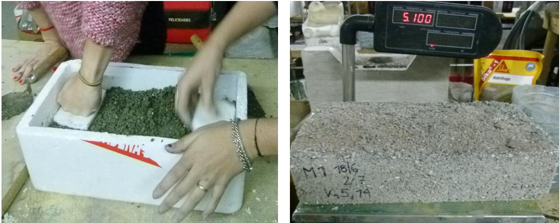
Fig. 3: Moldeo 1 para analisis de estandarización de llenado proceso y resultado
