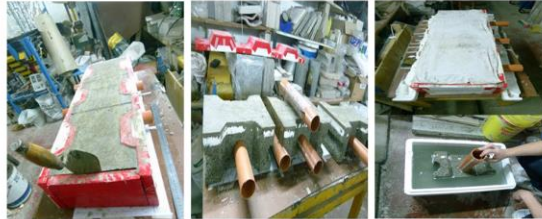
Fig. 2: Cuadro síntesis de fabricación de bloques elaborado para la modalidad CEP de finales ITC
