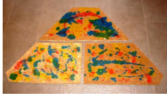
Fig.6: Cielorraso papel de bolsa de cemento + cola vinílica
