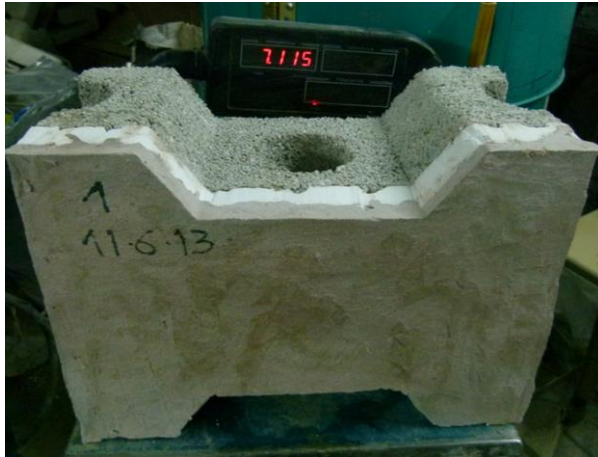
Fig. 5: Detalle de pesado de bloque terminado y detalles perimetrales
