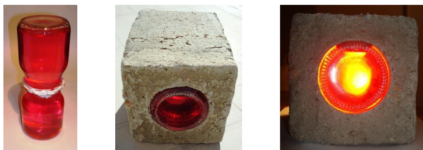
Fig. 15: bloques convectores con envases de vidrio reciclados
