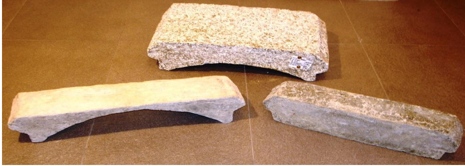
Fig. 16: bovedillas con las mezclas objeto de la investigación
