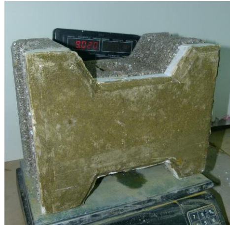
Fig. 6: Detalle de bloque terminado texturas e inter trabado de los mismos
