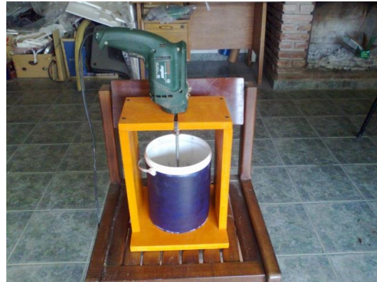
Fig. 12: licuadora con taladro en funcionamiento
