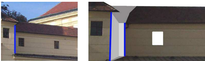
Obr. 7: Falešné hrany (např. modře vyznačené) vzniklé v důsledku zakrytí částí objektu na fotografiích jsou odstraněny. Nové hrany se vytvoří jako průniky ploch.
