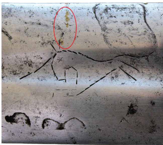
Obr. 6 Nezáměrně inkrustačním kovem zalité deprese na povrchu čepelí meče z hradu Buchlova inv. č. BU 959/290 [převzato z Žákovský et al., 2021b, s. 169] / Depressions unintentionally covered with inlaying metal on the surface of the blade of the sword from the Buchlov Castle, inv. no. BU 959/290 [taken from Žákovský et al., 2021b, p. 169]
