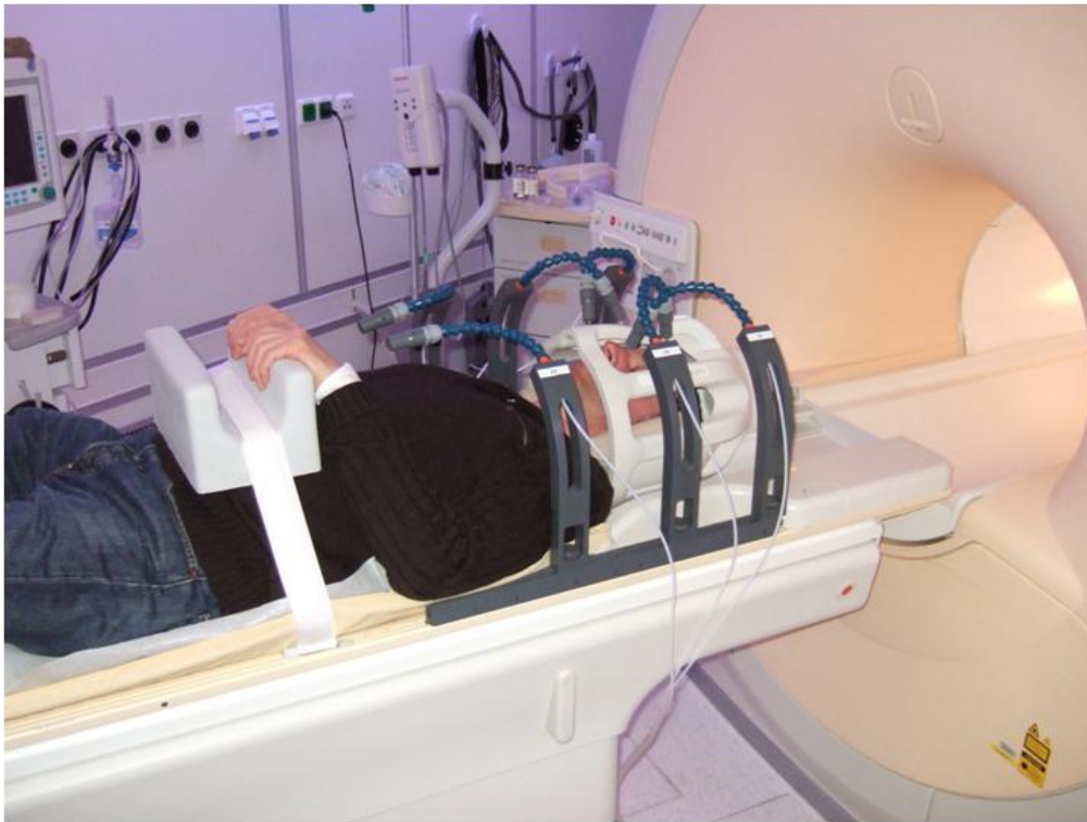
Abbildung 2.2 Lagerung eines Versuchsteilnehmers während der MRT-Messungen, Versuchsaufbau mit den 6 Positionierelementen der Stimulationsanlage.
