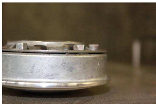
Variomatik mit 0,8mm U-Scheiben montiert
