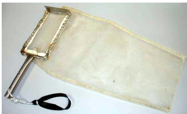
Fig. 5. Truel utilizado para la recogida de muestras por raspado en la zona intermareal e infralitoral.
