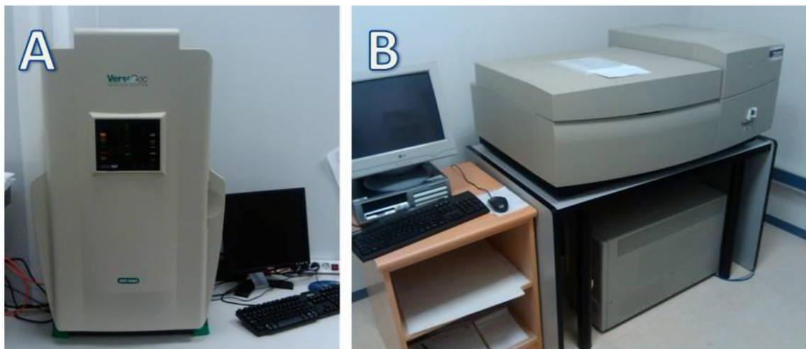
Figura 37: Distintos aparatos para la adquisición de imágenes según el tipo de tinción de los geles. Molecular Imager® VersaDoc™ MP 4000 System (A); Typhoon Scanner 9410 (B).
