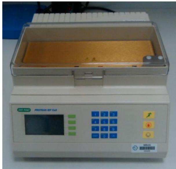
Figura 34: Imagen del aparato de isoelectroenfoque Protean IEF Cell utilizado para este estudio.
