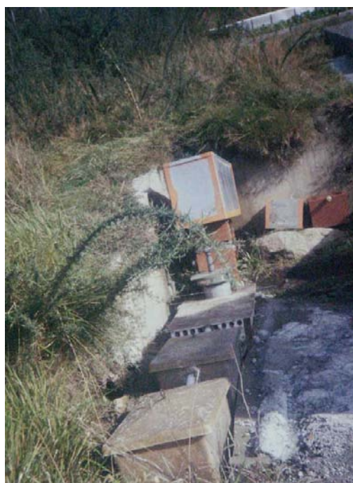
Foto 13 Toma da montaxe dos cinco conxuntos inseridos; de norte a sur temos: primeiro o depósito decantador de grossos, segundo o canxilón, terceiro o depósito colector - decantador de finos, cuarto o depósito colector de primeira alicuota e quinto o depósito colector de segunda alicuota
