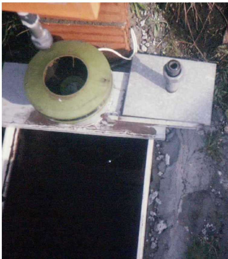
Foto 10 Vista dos diferentes transeptum entre o depósito colector - decantador de finos, o depósito colector de primeira alicuota e o depósito colector de segunda alicuota.
