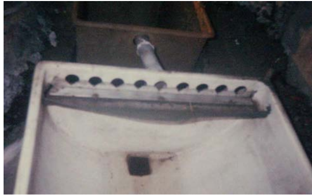
Foto 12 Toma na cal, de este a oeste, temos o depósito depósito colector - decantador de finos, o depósito colector de primeira alicuota e o depósito colector de segunda alicuota.
