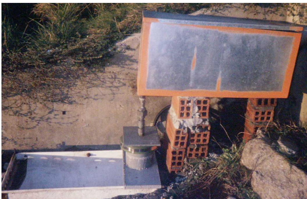
Foto 10 Vista dos diferentes transeptum entre o depósito colector - decantador de finos, o depósito colector de primeira alicuota e o depósito colector de segunda alicuota.
