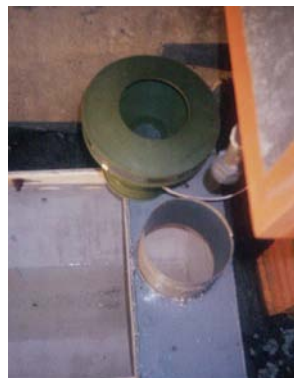
Foto 8 Exemplo post – funcionamento do canxilón e o depósito colector - decantador de finos
