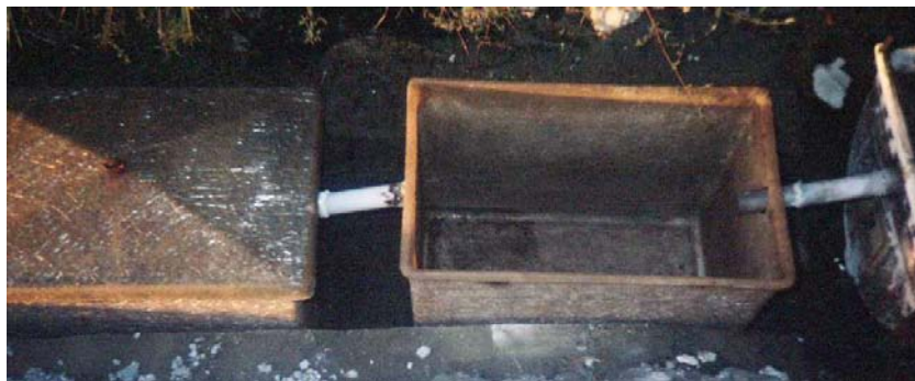
Foto 13 Toma da montaxe dos cinco conxuntos inseridos; de norte a sur temos: primeiro o depósito decantador de grossos, segundo o canxilón, terceiro o depósito colector - decantador de finos, cuarto o depósito colector de primeira alicuota e quinto o depósito colector de segunda alicuota
