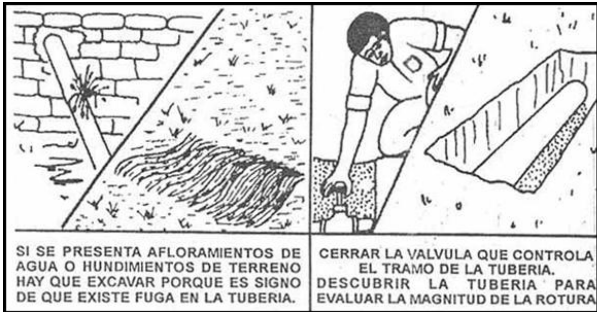
Figura 7. Inspeccionar la línea para detectar fugas y repararlas
