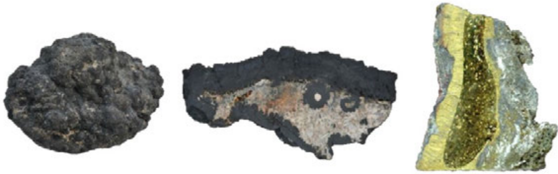
FIGURE 4.1: De gauche à droite : nodule polymétallique, encroûtement cobaltifère, sulfure hydrothermal. Source : Ifremer
